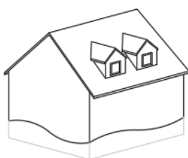
Stehgaube mit Satteldach
