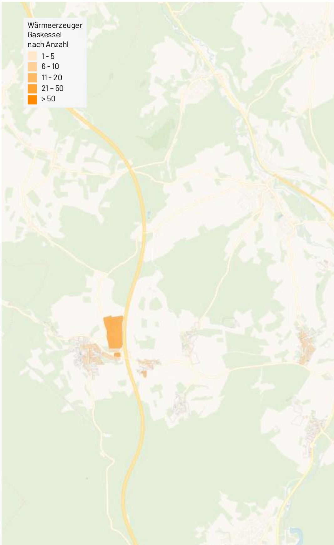
Abbildung 18: Baublockbezogene Darstellung dezentraler Wärmeerzeuger nach Anzahl und Art der Wärmeerzeuger (Gaskessel). Westlicher Kartenausschnitt.
