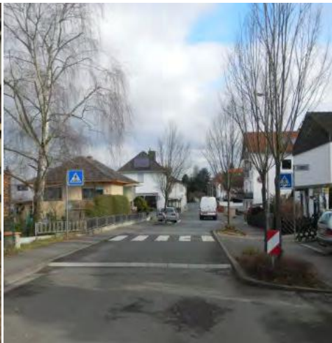
Beispiel 2: Aufpflasterung und Einengung
